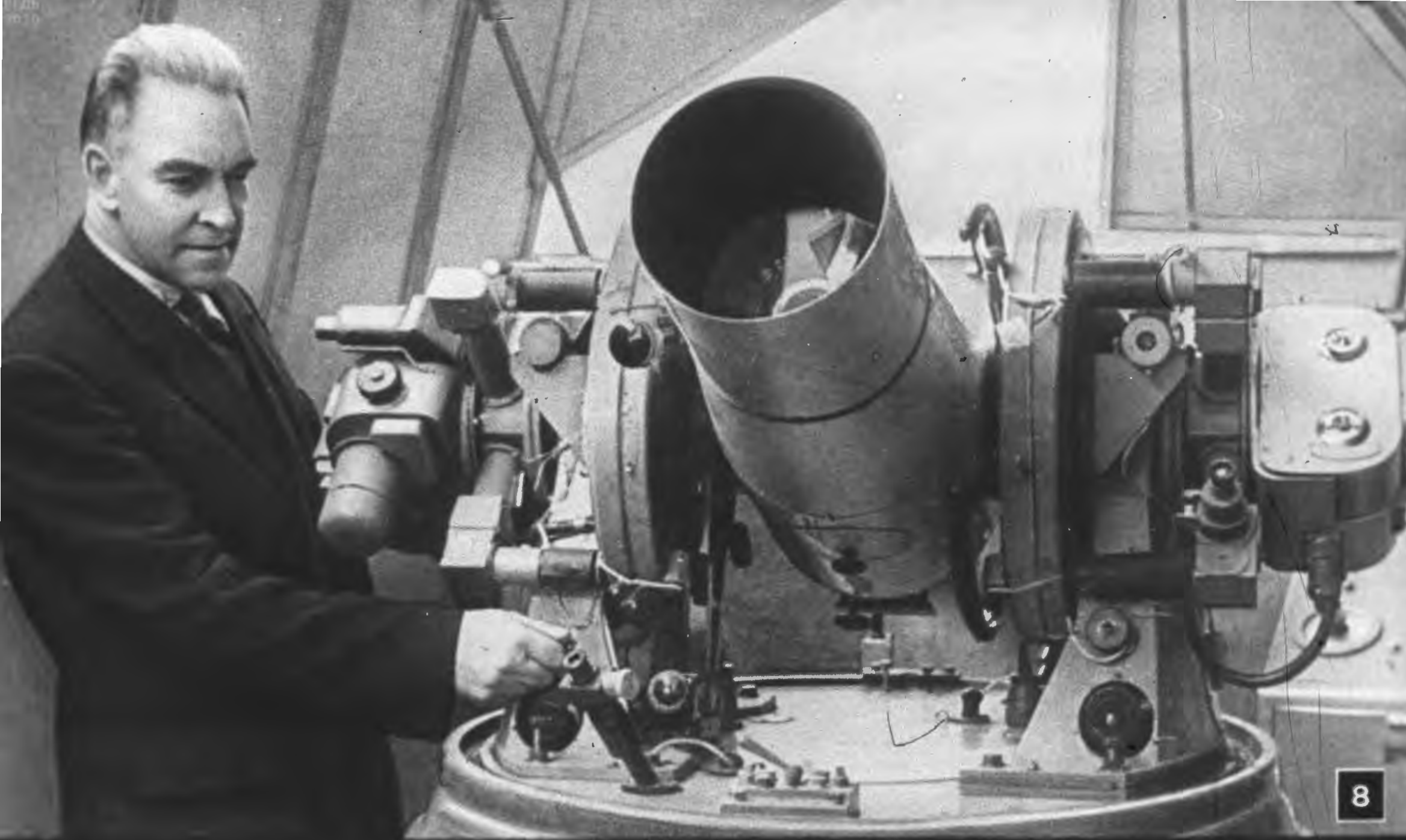
Фотографический вертикальный круг конструкции М. С. Зверева — один из новых инструментов для определения склонений звёзд.
